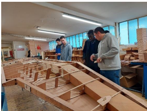
Architecture d'une aile 2: Aile d'un Robin DR401
